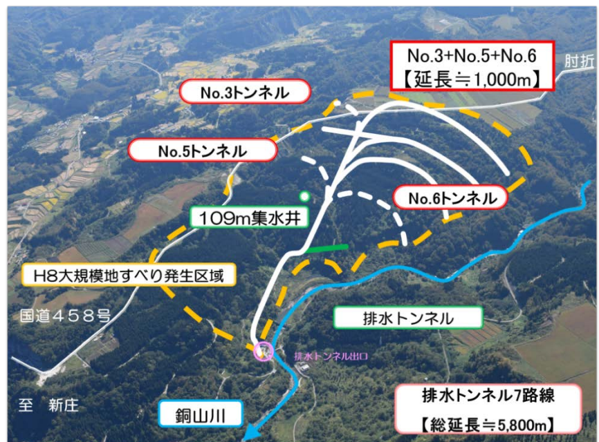
図2．排水トンネル計画図
