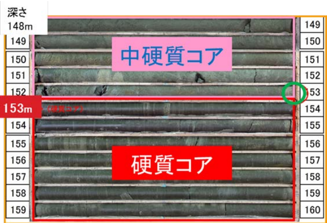
図 7. a 地点（破断面付近） コア写真
