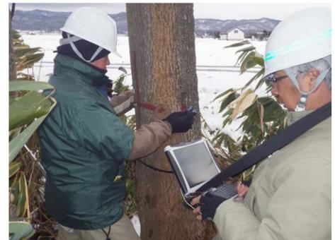
音波腐朽診断試験を行う研究者
