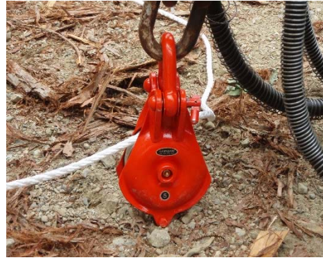
写真-4 改良したガイドブロック
