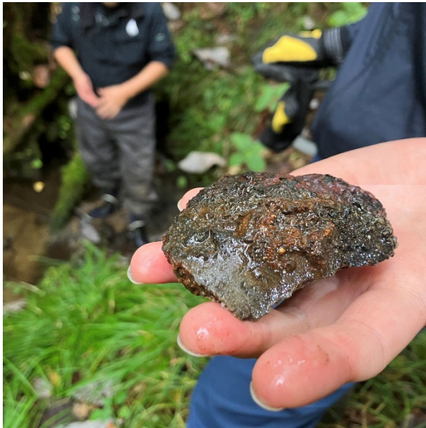
写真1 ふいごの羽口（土製の送風管）
