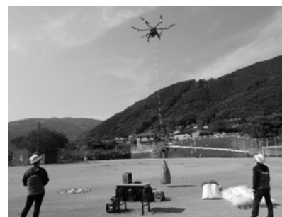
写真9 大型ドローンの苗木運搬
