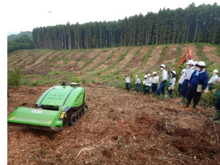
（写真2：クラッシャー地拵え作業地と自動下刈機）
