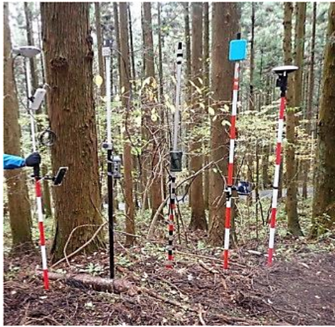
図 1-1 検証に用いた高精度 GNSS 受信機 右から 2 周波 GNSS 受信機 （DG-PRO1RWS、TK-1LT、GG-2） 左から CLAS 対応 GNSS 受信機 （QZR-SP、Cohac∞10）
