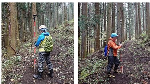
図 1.5 GNSS 受信機による測位
