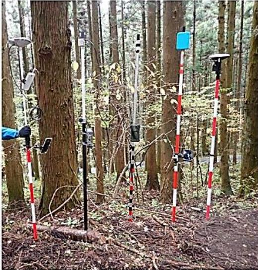
図 1.6 精度検証に用いた GNSS 受信機
