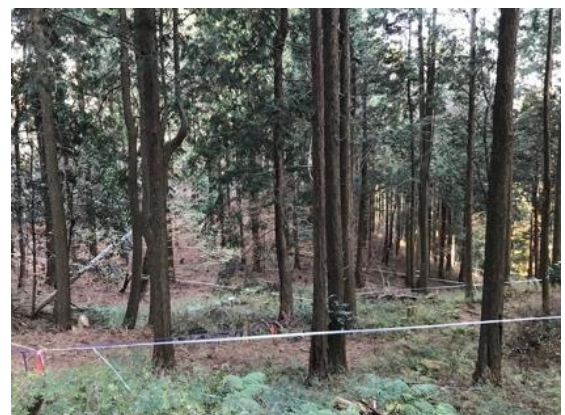
図 4.1.4 レーザ計測箇所の目安とした 10m メッシュのテープ表示 林内の縦横に 10m 間隔でテープを張り巡らせてある。
