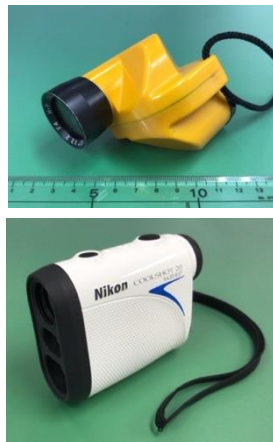
図 4.1.5 地上レーザ計測に便利な携行機材 上：方位を計測するコンパスグラス 下：簡易なレーザ距離計測
