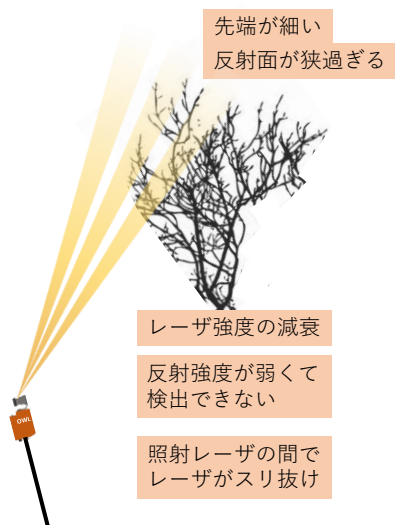
図 5.1.9 枝がレーザ照射をすり抜けるイメージ図
