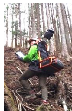
地上レーザ計測装置 3DWalker (背負子型)
