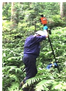
地上レーザ計測装置 OWL (一脚型)
