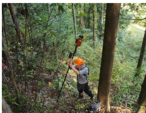
**図 2.3.5 地上レーザースキャナ計測
