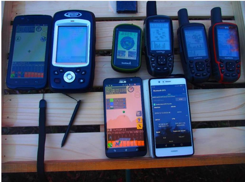
図 10.1.1 精度検証に用いた GNSS 受信機
