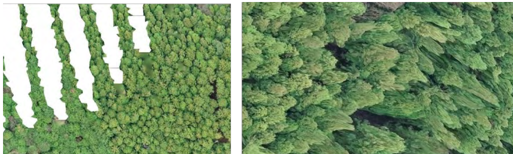
図5.2.2 オーバーラップ率が低い場合に生じやすいオルソ画像の乱れ オルソ画像の周縁部等に発生しやすい「欠損」(左)や「ぶれ」(右)
