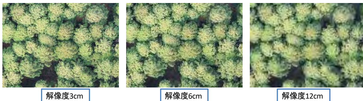
図5.2.1 解像度によるオルソ画像の画質の変化 対地高度による解像度の違いを画素数の変化によって疑似的に再現した。
