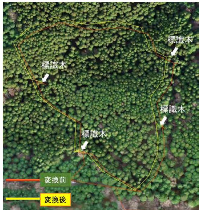
図5.3.2 アフィン変換によるオルソ画像の幾何補正 外周の標識立木を用いてアフィン変換することでオルソ画像の「ゆがみ」やコンパス測量に内在する誤差が解消され、区域測量成果を挿入できる。
