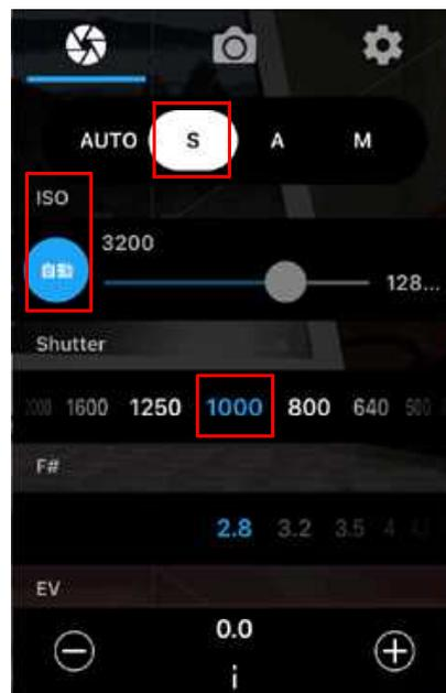
カメラ設定は基本的なものとして、上から「シャッタースピード優先(S)」、「ISO 感度自動」、「シャッタースピード 1/1000」となる。ただし、当日現場の天候等に合わせて露出 (EV) を変更する等、調整が必要となる。
