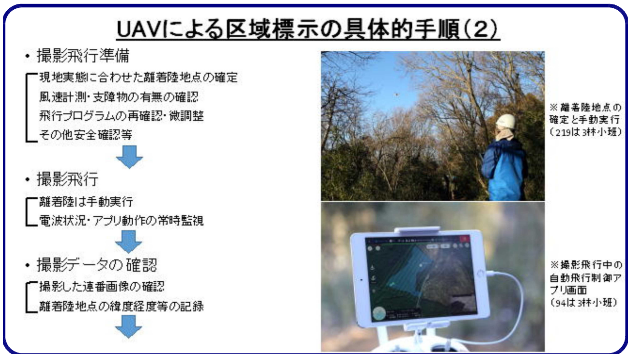
図3.1.6 UAVによる区域標示の具体的手順 (2)
