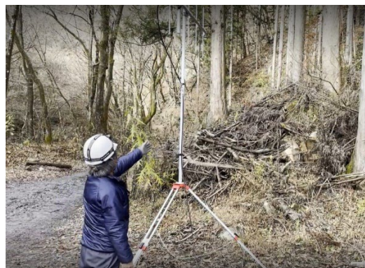
図 24 アンテナ方位 (方位) 決定作業
