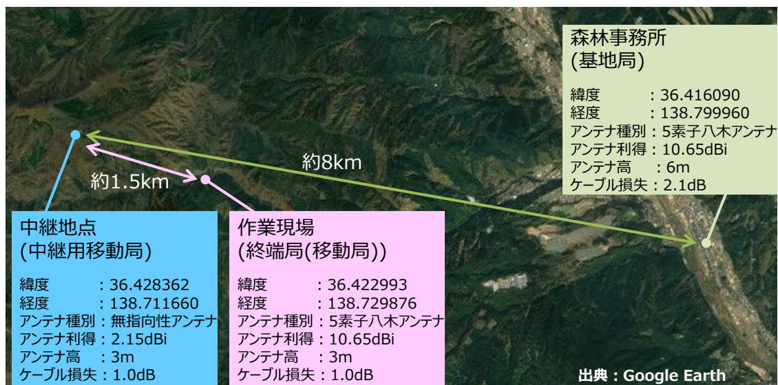
図 参 4-7 シミュレーション結果に基づくバックホール回線
