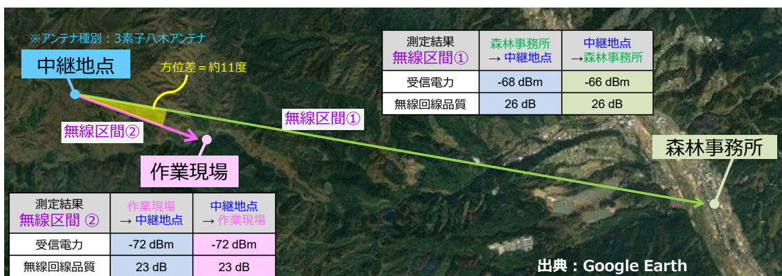
図 2.17 事前現地調査での簡易測定結果
