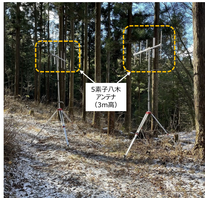
図 2.8 終端局（移動局）のアンテナ設備 (5素子八木アンテナ、受信ダイバーシチ構成)
