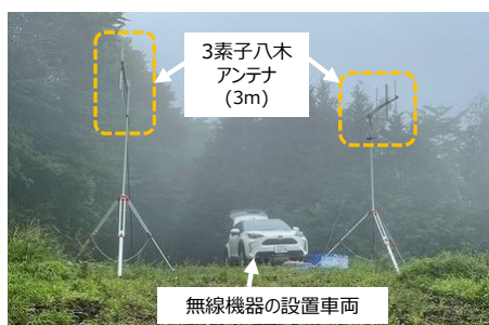
(b) アンテナと無線設備の設置車両
