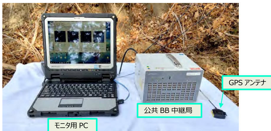
図 2.16 公共 BB 中継局設備外観 (岩氷林道 (西側))
