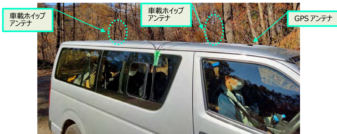
図 2.21 公共 BB 終端局設備（車載アンテナ）外観（車両移動時）
