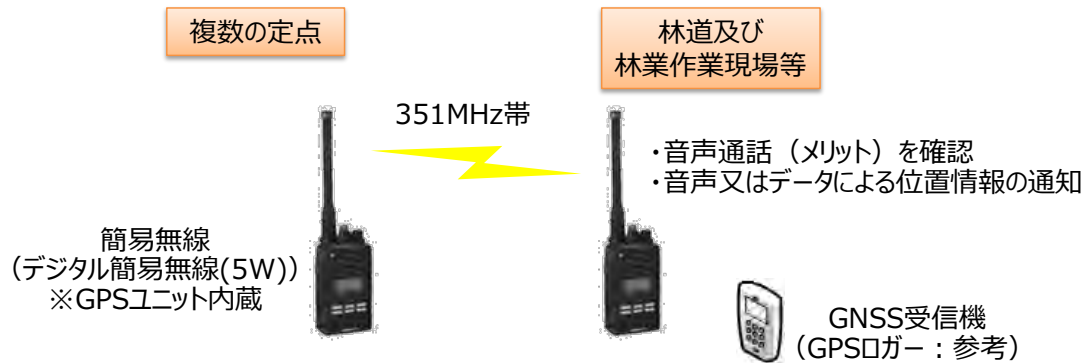
図 2.11 試験系統図 (デジタル簡易無線による通信試験)
