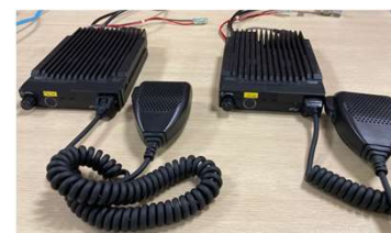
(参考) 無線機の外観図 上: デジタル業務用無線 下: デジタル簡易無線
