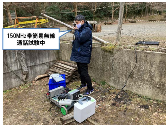
(a) デジタル簡易無線（150MHz 帯）による通話確認（日影沢キャンプ場）
