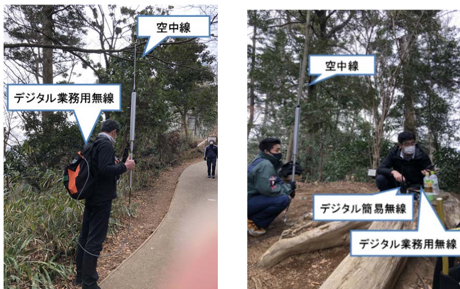
図 3.21 デジタル業務用無線（150MHz 帯）による試験風景（いろはの森案内板付近）
