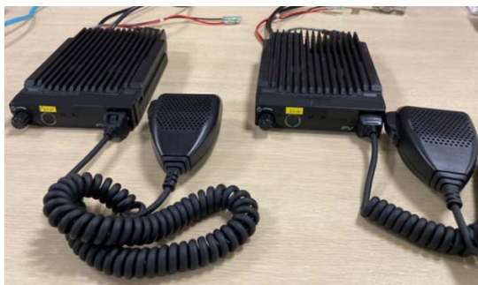
図 3.14 デジタル業務用無線 (150MHz 帯) 無線本体部 (車載型) 外観図
