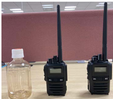
図 3.15 150MHz 帯デジタル簡易無線 (150MHz 帯) 携帯型外観図
