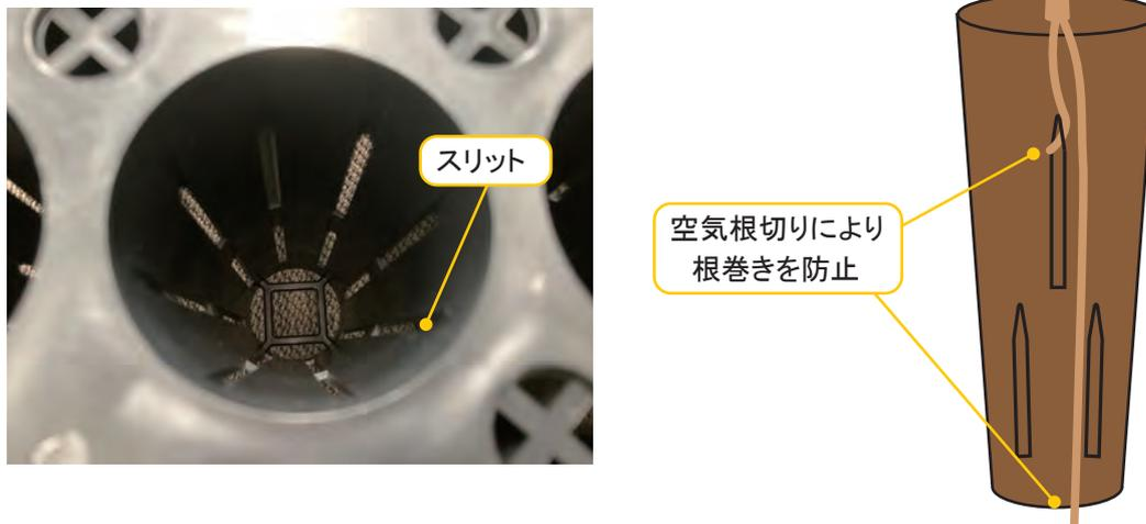
図7 サイドスリット型コンテナ (MT-150-40P) の側壁のスリット構造 (左) と根巻き防止のイメージ (右)
