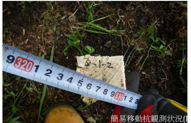
図 15 簡易移動杭設置・観測状況
