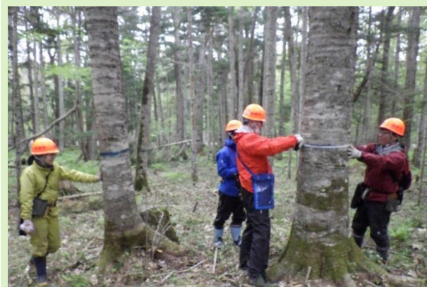
直径巻尺による胸高直径測定
