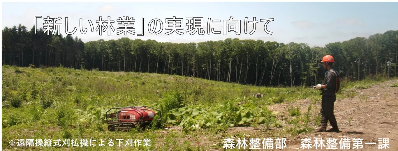
※遠隔操縦式刈払機による下刈作業
