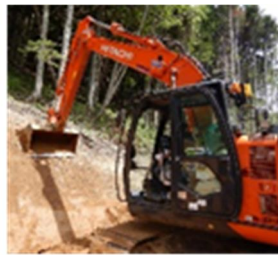
土木機械と設計図が連携することで作業すべき位置を運転席でモニターしながら作業可能
