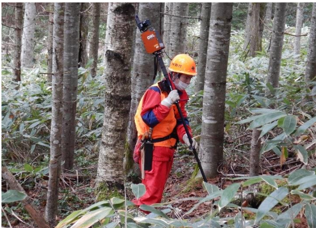
地上型3Dレーザーによる測定中の様子
