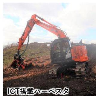
樹幹の長さや太さを計測し、丸太価格を踏まえた最適な長さにカットしてくれます！
