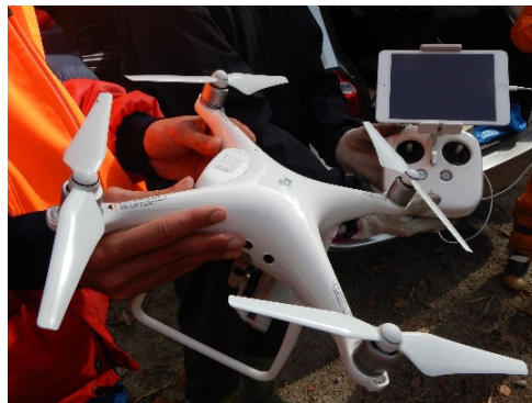
小型UAVによる空中写真撮影
