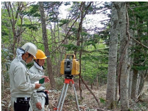
レーザースカナーによる3D測量の様子
