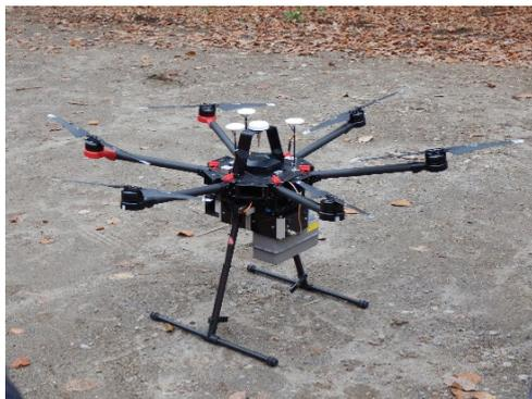
各種センサーを搭載した大型UAV
