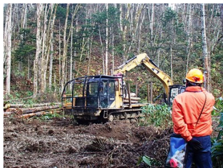
フォワーダによる搬出作業
