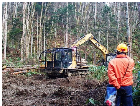
フォワーダによる搬出作業
