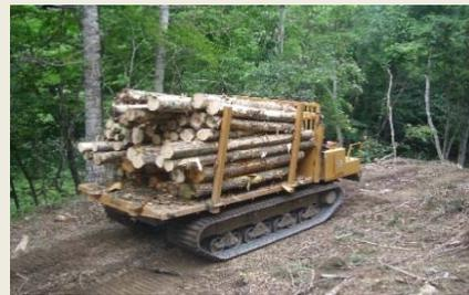
フォワーダによる丸太の運搬
