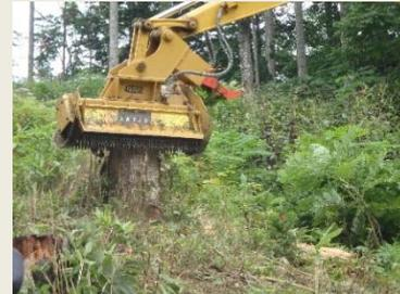
写真7: クラッシャによる伐根破碎
