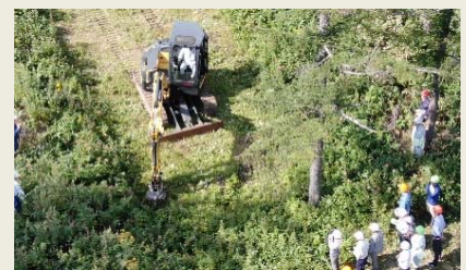
写真12: 油圧ショベル装着草刈り剪定刃を使用した現地検討会
