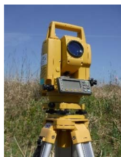
写真② 測量器械：トータルステーション
