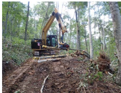
高性能林業機械による間伐作業
