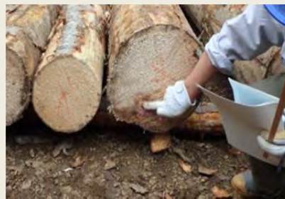
写真8 木口の欠点を確認
