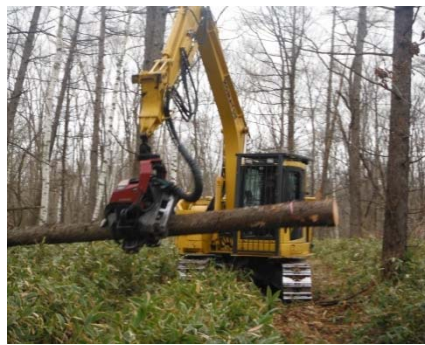
ハーベスターによる伐倒・造材
