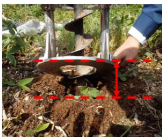
コンテナ苗植付用部品を取り付けたアースオーガ
