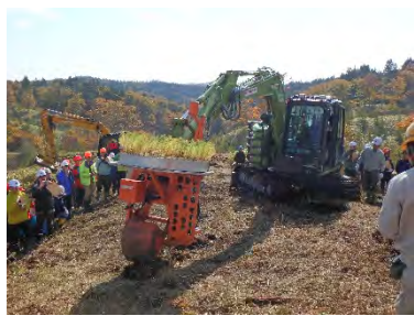
現在、開発・実用化が待たれる コンテナ苗の自動植付機
