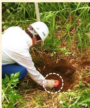
(写真④) 境界巡検の様子 境界標識周囲の雑草を刈払い、頭部に赤スプレーを塗布している 中央下の囲みが境界標
