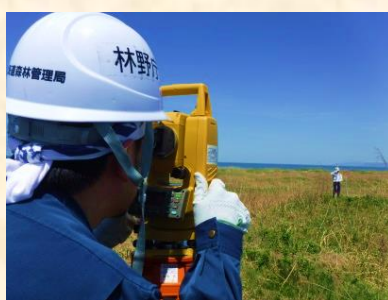
(写真⑤) 不明となつた境界標識を測量成果に基づき探索する様子
