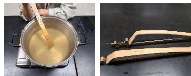
写真3 先端部の曲げ作業
