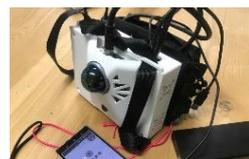
図1. 地上LiDAR (Mapry社製のLA03)
