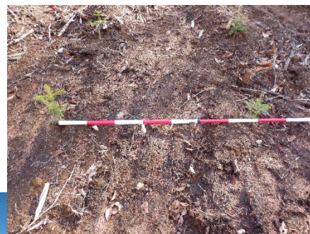
図4. 測量ポール等を添えることで正確に計測可能(上)
