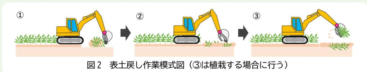
図2 表土戻し作業模式図(③は植栽する場合に行う)
