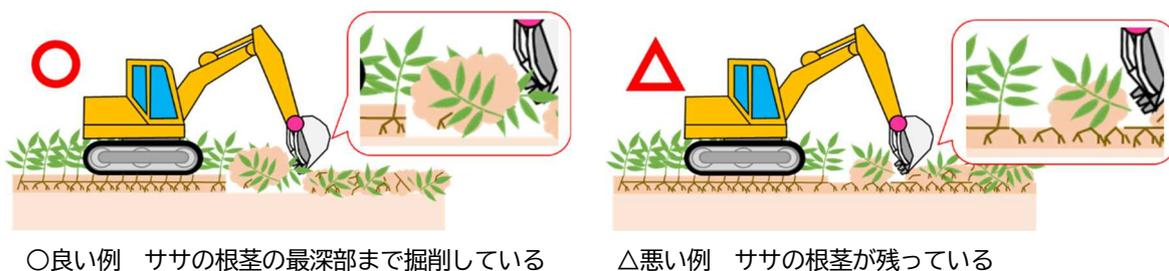
図3 表土掘削の模式図
