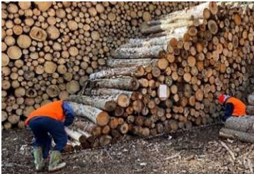
巻尺を用いた手作業計測 (測定単位は0.1m)
