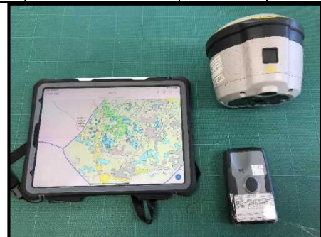
写真. 測量に必要な機器 iPad (左), R1 (右下), R2 (右上)
