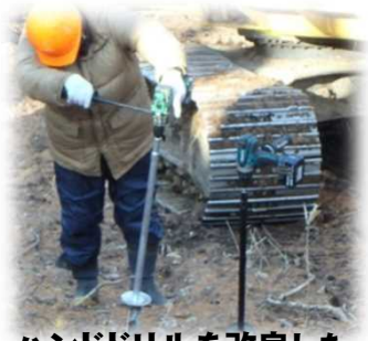
ハンドドリルを改良した電動植穴掘機
